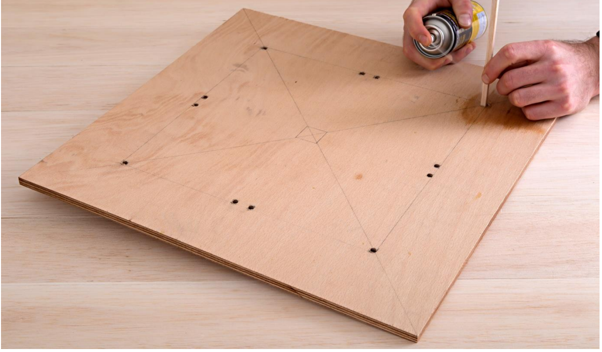
Şekil E13: Kolonun Taban Plakasındaki Yerine Yapıştırılması
