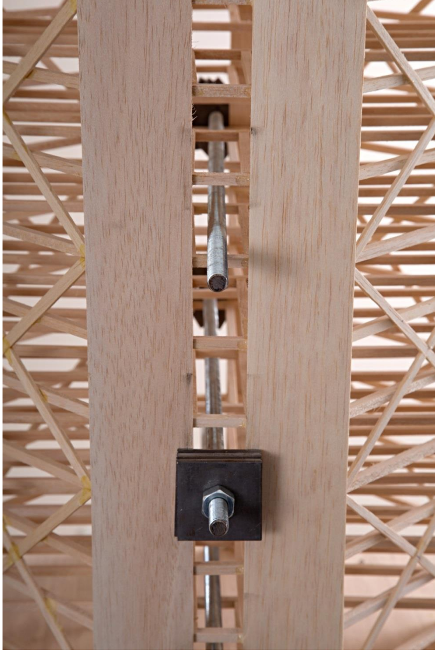
Şekil E5: Kat ağırlık çubuğu 1.3cm genişliğinde bir boşluktan geçirilerek sıkıştırılmalıdır. Bu fotoğrafta YANLIŞ BİR UYGULAMA olarak 1.3cm olması gereken boşluk daha fazla bırakılmıştır.
